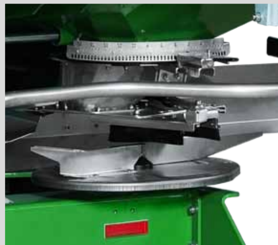
UKŁAD WYSIEWAJĄCY Z WIDOCZNĄ SKALĄ ORAZ SZCZOTKAMI
